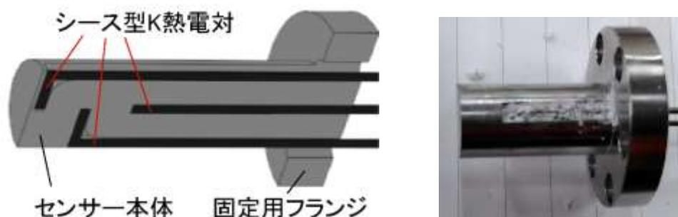
Fig.1 空力加熱センサーの概要図
