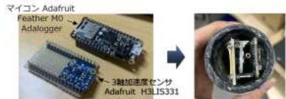
図 3 加速度計測装置
